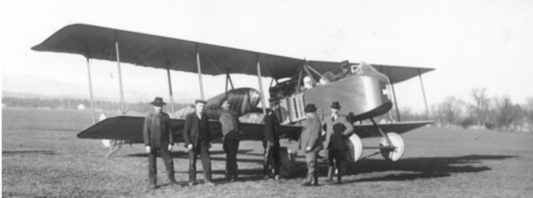
Die DH-1 erregte einiges Aufsehen, da der Beobachter (mit Maschinengewehr) vor dem Piloten sass. Jedoch befriedigten Leistung und Flugeigenschaften der Maschine nicht und es folgte das Modell DH-2, bevor sich mit der technisch ausgereifteren DH-3 der Erfolg einstellte.
